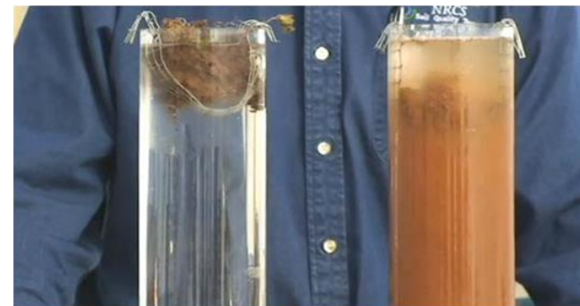
Stabilité structurale (par ex. Slake test en photo)
